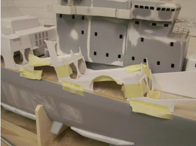
Damit die Grundkonstruktion auch schön aufs Deck passt, klebte ich mit Klebeband die einzelnen Teile provisorisch aufs Deck. Da das Deck noch gewölbt ausgebildet ist, musste jedes einzelne Teilchen dem Decksverlauf angepasst werden
