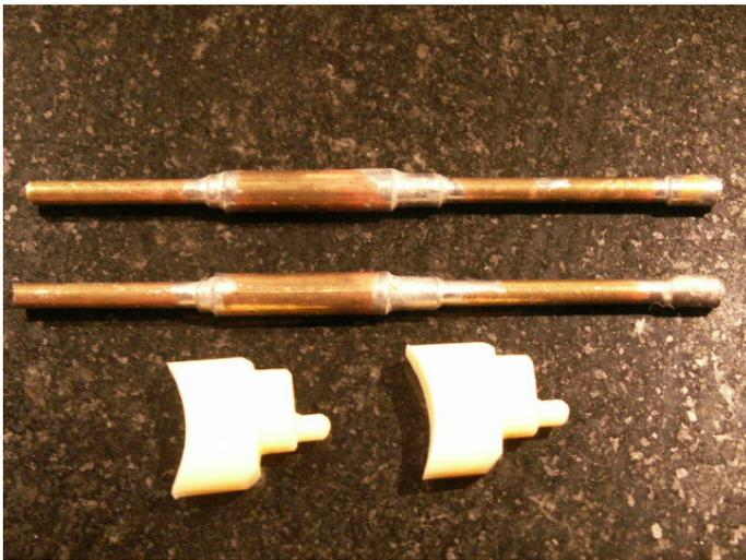
Die Laufaufnahmen fertigte ich ebenfalls aus Resin, auch hier hatte ich noch eine Slikonform. Die Läufe selber bestehen aus mehreren aufeinander gelöteten Messingrohre in verschiedenen Durchmessern. Die hier abgebildeten Rohre sind erst der Rohling. Nun muss ich die genaue Kontur noch herausdrehen.
