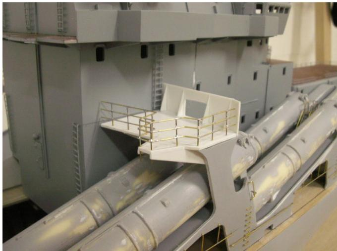
Detailaufnahme eine Podestes zwischen den Silos. Die Podestfläche wurde aus einem 0.2mm Lochblech (Ätzteil) aus Messing gefertigt. Die restlichen Teilchen sind wieder aus 0.5mm Messingdraht zusammengelötet. Von diesen Podesten musste ich 8 identische Stücke herstellen, was nicht ganz einfach war.
