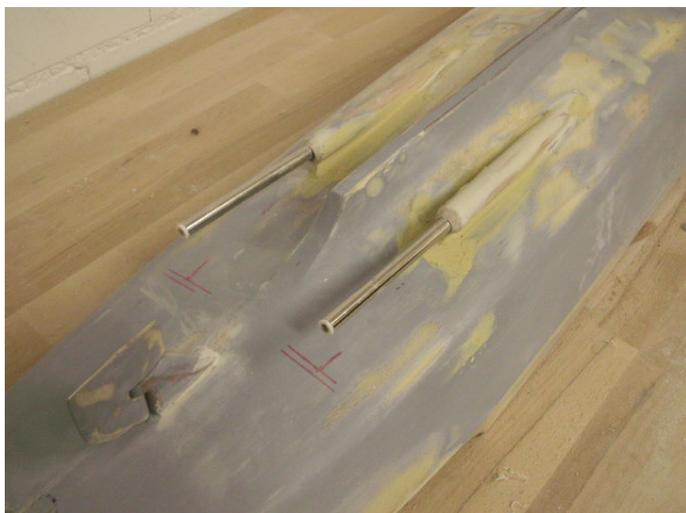
Die Löcher für die Stevenrohre sind nun bereits gebohrt. Die vorgängig in die Spanten angebrachten Stevenrohr-Führungen waren mir da eine sehr grosse Hilfe. Ein eigentliches Ausmessen und Ausrichten der Stevenrohre ist so fast hinfällig. Löcher gebohrt und Wellen eingeschoben, fertig.
