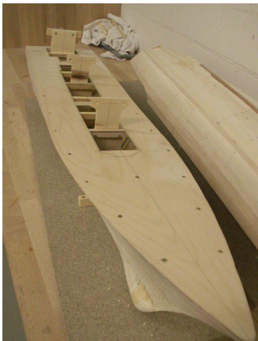
Und wieder geht es mit kleinen Schritten vorwärts. Nun ist das Deck montiert. Im vorderen Bereich verschraubte ich das Deck zusätzlich mit den Spanten, weil in diesem Bereich die Sperrholzplatte auf zwei Seiten gekrümmt werden musste. Ich hoffe das die do recht kleinen Öffnungen für die RC-Anlage genügen....
