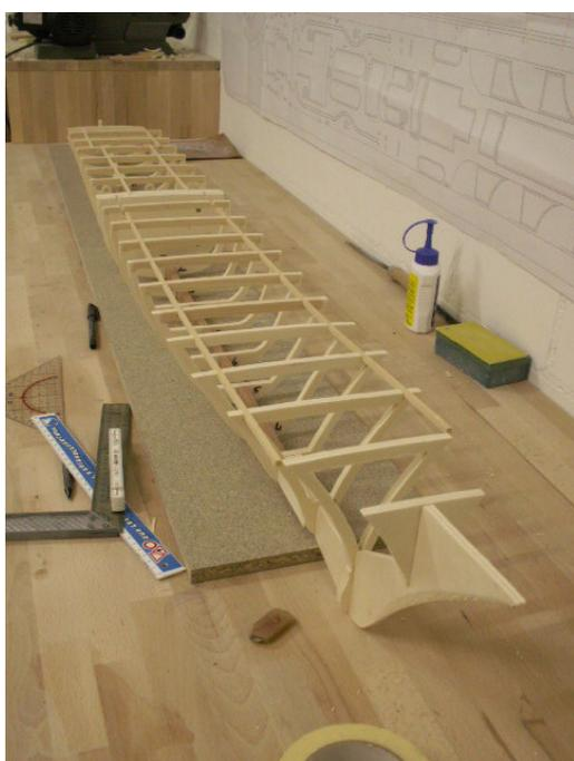
Die Helling wurde ebenfalls 2-Teilig ausgebildet. Trennstelle genau am selben Ort, wo auch der Rumpf getrennt wird. So kann ich nachdem der Rumpf beplankt und verschliffen ist. Die beiden Hälften auseinander ziehen und einzeln mit Epoxyd bepinseln.
