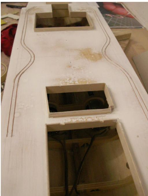
Zeitgleich fertigte ich die Schienen auf dem Deck. Diese entstanden aus 0.6mm Kupferdraht, den ich mit Sekundenkleber aufs Deck klebte. Danach wurde alles noch sauber gespachtelt.
